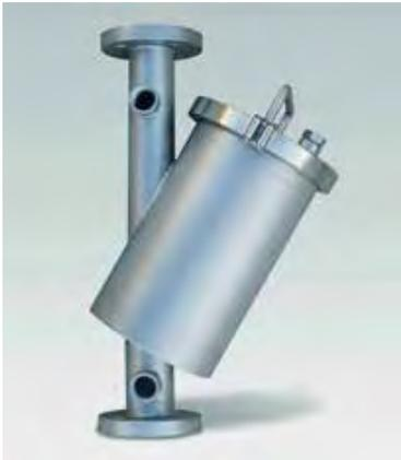
Filtro con la configuración de filtración invertida (FITO - dentro a fuera) en base a retener las partículas en la carcasa del filtro, equipado con apertura rápida para obtener una rápida intercambiabilidad y limpieza de la canasta.
