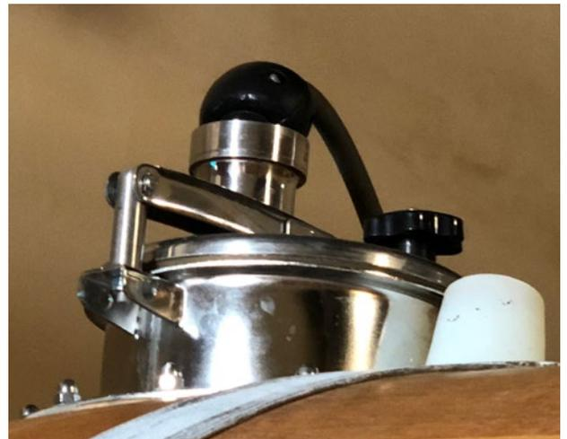
Utilizamos nuestra caña HR55 con una longitud de 140 mm, necesitamos una hidrolavadora de agua caliente con un caudal de 1000 a 1200 L/Hr a 180 Bares. Esta está suspendida por la manguera AP, con el objetivo de posicionarla en el punto medio de la altura. El diámetro máximo de acción es de 2300 mm.
