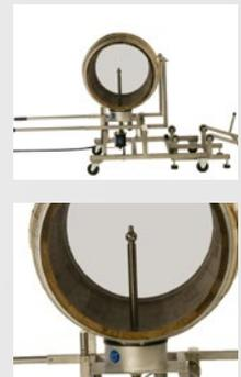
Dispositivo lavabarricas móvil con carga manual de las barricas que permite una limpieza fácil y rápida. Se carga la barrica mediante una rampa y se coloca manualmente en la posición de limpieza. El modelo FR1C es además ajustable, así se pueden lavar barricas de hasta 600 litros.
