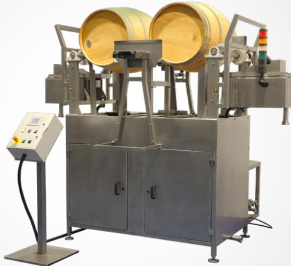
Lavabarricas automático para 2 barricas sobre durmientes. Limpieza simultánea de dos barricas. Las cuales son posicionadas junto con el durmiente mediante carretilla elevadora sobre el equipo de limpieza. La introducción de los cabezales de limpieza en las barricas es completamente automática.
