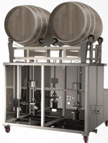
Limpeza simultánea de dos barricas, apiladas sobre durmientes/racks. Se colocan sobre el equipo con una carretilla elevadora. El cabezal de limpieza se introduce manualmente. Dependiendo del equipamiento, se puede realizar una limpieza automática con agua fría, caliente, con vapor y tiempo para escurrir.
