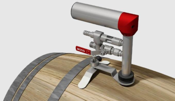
Equipos portátiles, limpian el interior de la barrica y aspiran al mismo tiempo el agua sucia. Nuestro sistema de inyección integrado genera un vacío muy grande el cuál aspira perfectamente la barrica durante y tras el proceso de limpieza. Ya no es necesario girar y escurrir la barrica.
