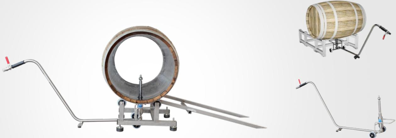
Lavabarricas para la limpieza de barricas sobre durmientes. El cabezal rotativo se introduce desde abajo en la boca de la barrica, por donde también sale el agua sucia. Accionamiento hidráulico del cabezal rotativo para una limpieza muy cómoda y segura de las barricas.
