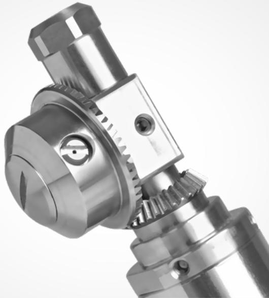
El cabezal de limpieza R40 tiene un cabezal pulverizador tridimensional con proyección de 360°. Es aplicable universalmente y es muy compacto ya que el cabezal mide 40 milímetros de diámetro. Las toberas de alta presión están montadas en la carcasa de los cabezales.
