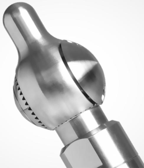
El cabezal de limpieza RK tiene un cabezal pulverizador rotatorio tridimensional con una proyección de 360°. Con un diámetro muy pequeño del cabezal, bordes redondeados y engranajes cubiertos fue diseñado para la introducción en aperturas muy estrechas del depósito.
