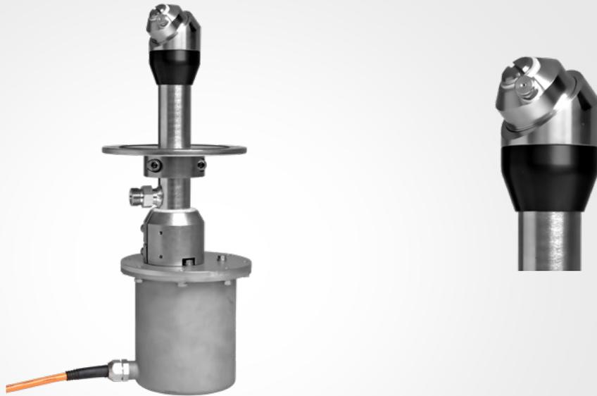
El Mixer Washer es un limpiador de depósitos diseñado especialmente para las demandas específicas de la limpieza de hormigoneras. Con un rociado de 270°, impermeabilización eficaz de los engranajes evitando la penetración del polvo de hormigón, accionamiento eléctrico y brida de fijación con un dispositivo para ajustar el cabezal, cumple con todas las necesidades
